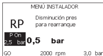
Figura 17: Configuración de la presión de reencendido
